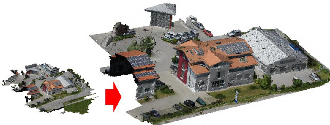
3Dプリンタでは上限のファイル容量があるため、「簡略化」コマンドでデータ量を減らしておきます。今回は3Dプリンタのスライスピッチにあわせて0.02mmの精度を指定して簡略化を実施。データ量を約半分の18万ポリゴンにすることができました。精度指定をしたので指定精度以上に形状は変わりません。
